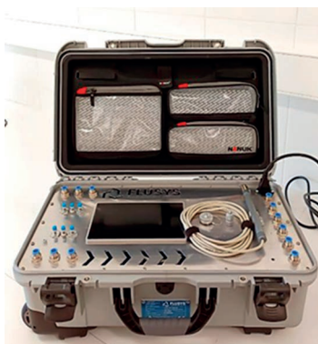
Figura 2 – Equipamento para captura de voláteis constituído por seis bombas de ar construído para o projeto PurPest numa colaboração entre a empresa Flusys® e o Instituto Julius Kühn, Alemanha.
